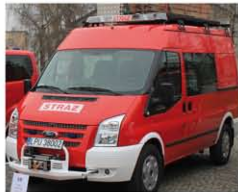
Ford Transit posiada silnik 2.2 TDCI o mocy 100 KM i momencie obrotowym 310 Nm, 6-cio biegową skrzynię manualną i napęd na tylną oś.
